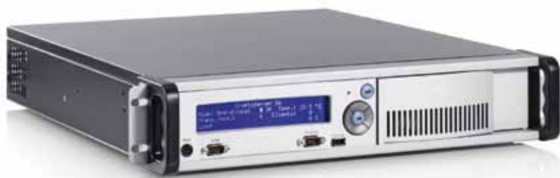
R&S®CryptoServer wird in verschiedenen Versionen angeboten, als Einsteckkarte (PCI-/PCIe-HSM) und als komplette Server-Appliance im Rackformat (LAN-HSM).
